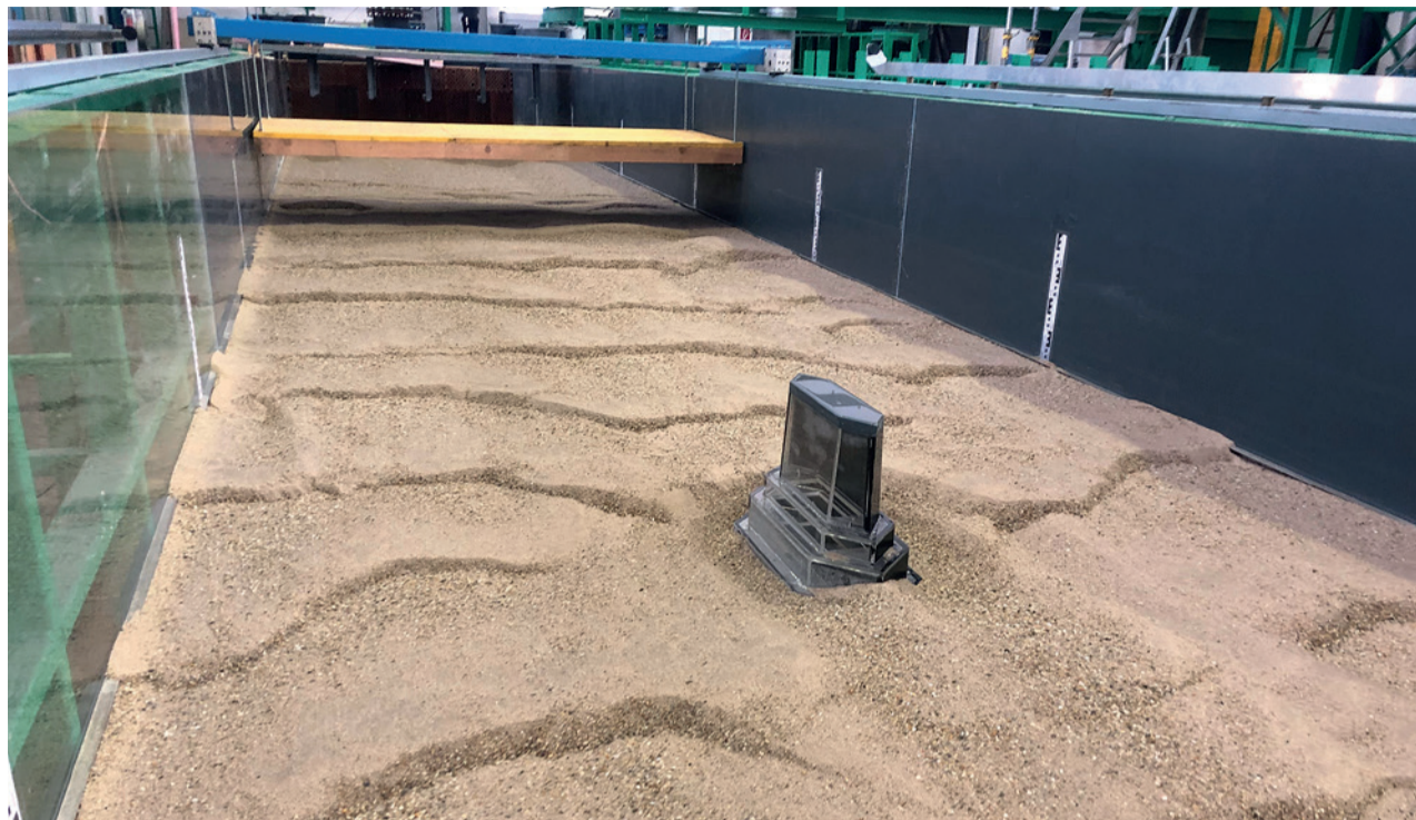
Die Tiefstellen an Brückenpfeilern werden am Beispiel der Brücke Höchst / Lustenau im Detailmodellversuch in Wien untersucht.
