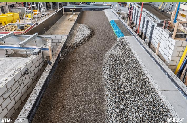
Zürich: Detailmodellversuch Dammfussssicherung ETH Zürich, VAW, Masstab 1:35
