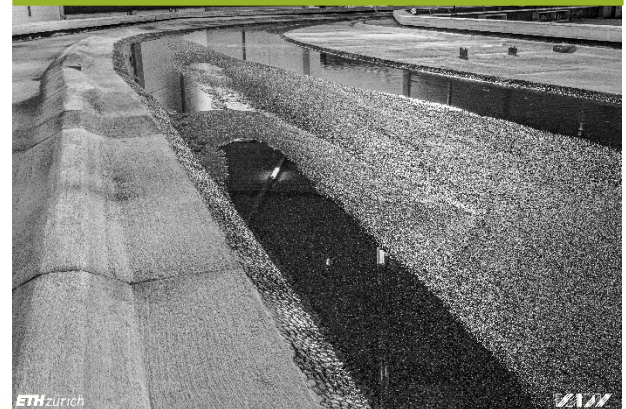
Dornbirn: Modellversuch Flussmorphologie ETH Zürich, VAW, Masstab 1:50
